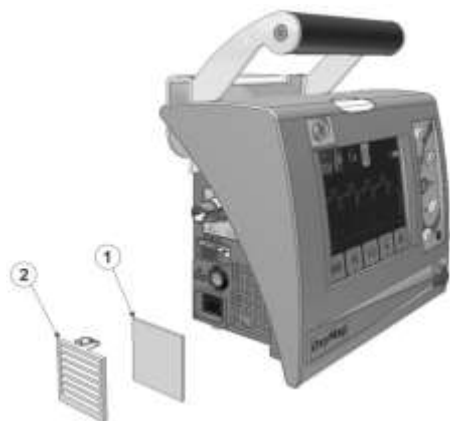
Figura 17: Exemplo para troca de filtro de ar
